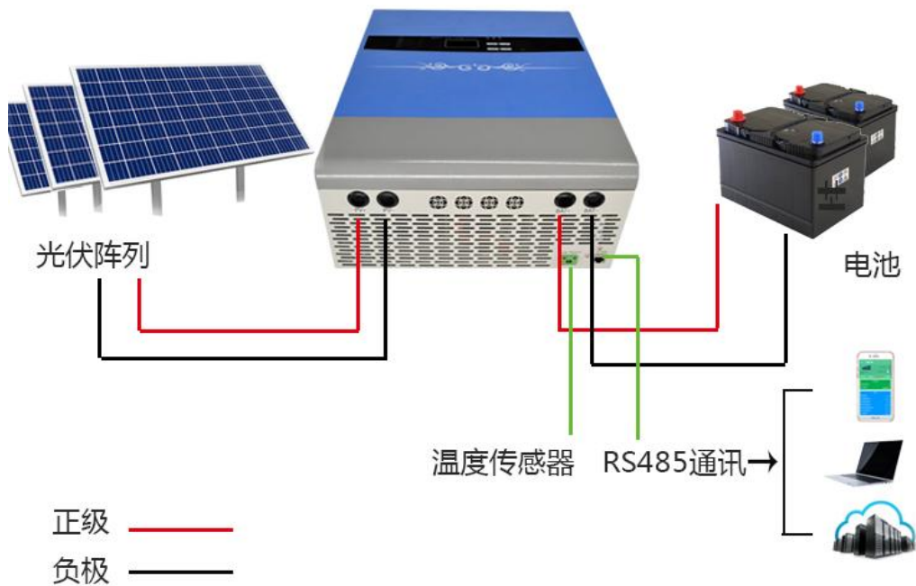
图 3-2 JN-HV 系列 MPPT 控制器接线图
